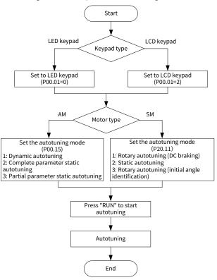
Figure 6-4 Motor parameter autotuning
